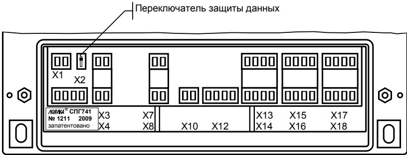
Рисунок 3.2 б – Монтажный отсек корректора СПГ741.02
